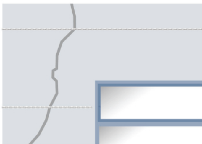
ремонт и усиление оштукатуренных стен с трещинами
