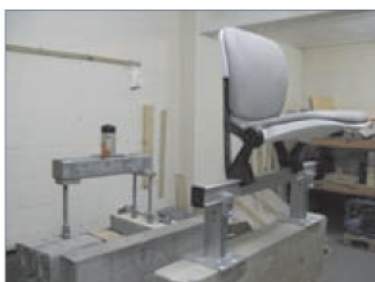
Испытания анкера SureFit с усилием 10.0 кН с расстоянием до края конструкции 20 мм
