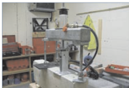
Испытания анкера SureFit с усилием 10.0 кН с расстоянием до края конструкции 20 мм
